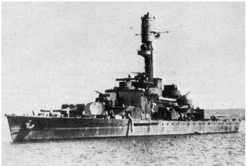
Panssarilaiva Väinämöinen. Pituus 93 metriä. Aseistus: 4 × Bofors 254 mm, 8 × Bofors 105 mm, 4 × Vickers 40 mm, 2 × Madsen 20 mm.
