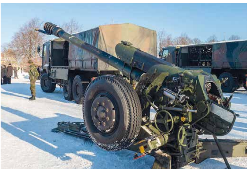
Kenttähaupitsi 122 H 63 on Puolustusvoimissa laajasti käytetty tykki. Kuva Jukka Eklind
